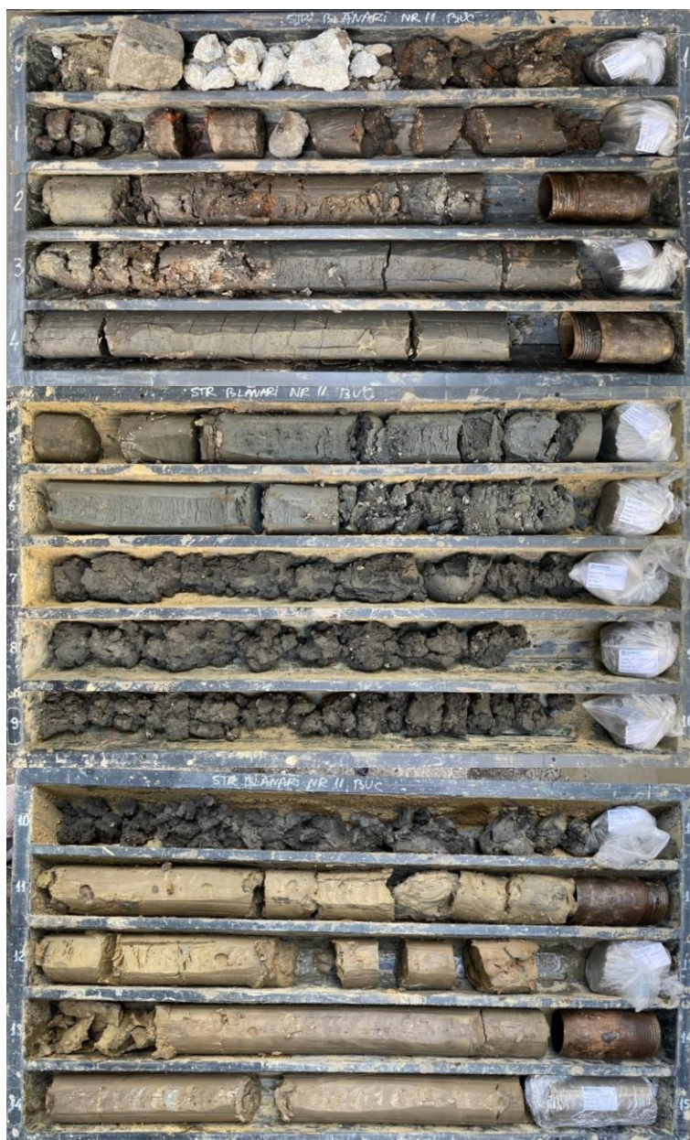
Figura 9. Fotografie cu terenul din amplasament rezultat în urma forajului geotehnic
